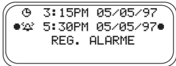
*Afficheur de réglage de l'alarme pour une date et un moment précis*
